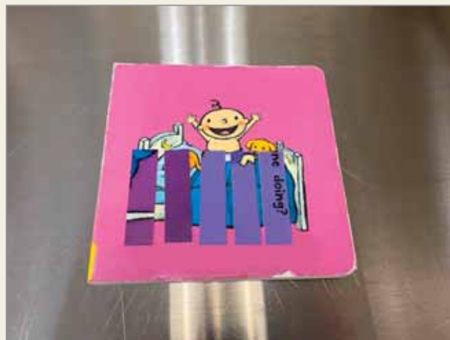
Рис. 4. Нанесение SARS-CoV-2 на детскую картонную книгу (Тест 2). После инокуляции полоски-образцы вернули в документ, из которого они были взяты
