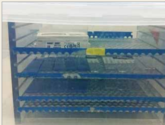
Рис. 6. После инокуляции образцы поместили в камеру с установленными значениями температуры и относительной влажности
